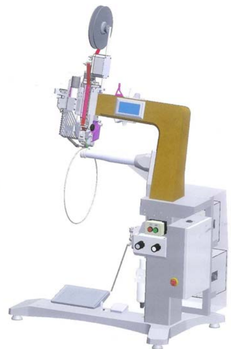
bras latéral pour soudage cylindrique
